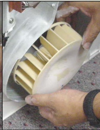
Remove rear fan (13mm socket)
