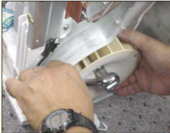
Remove rear fan (13mm socket)
