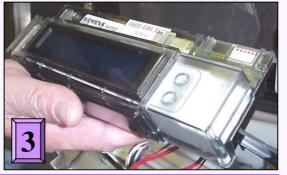
Removing display module
