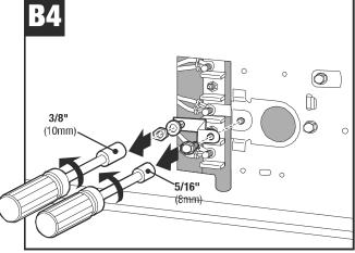
Remove nut and exterior bolt from ground strap./ Enlevez l'écrou et le boulon extérieur du ruban de mise à la terre./ Retire la tuerca y el perno exterior de la cinta de conexión a tierra.
