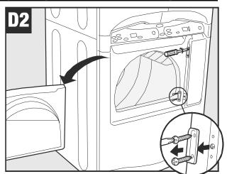
Remove door and hinge covers./Enlevez la porte et les couvercles de chamières./Retire la puerta y las cubiertas de las bisagras.
