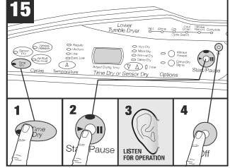
Test to see if the dryer is operational./Vérifiez que la sécheuse fonctionne./ Verifique si la secadora funciona.
