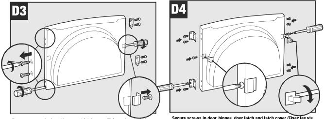
Remove screws in door, hinges and latch cover./Enlevez les vis de la porte des chamières et du couvercle de verrou./Retire los tornillos de la puerta, de las bisagras y de la cubierta del seguro.
