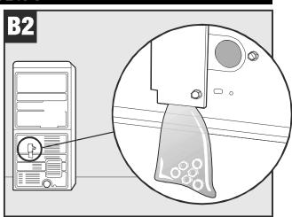
Nuts and washers for connecting electrical cord to machine./Écrous et rondelles pour le raccordement du cordon électrique à l'appareil./ Tuercas y arandelas para conectar el cordón eléctrico a la secadora.
