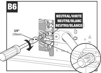
Attach neutral wire to center post, (*NOTE: Use deep well nut driver* for all connections to assure tight fit on all terminals.)/Raccordez le fil de neutre au goujon central. (*Remarque : Utilisez une douille profonde pour tous les* raccordements pour vous assurer que toutes les bornes sont bien serrées.)/ Instale el alambre neutro en la clavija central, (*NOTA: Use la llave de tuerca de* casquillo profundo para todas las conexiones a fin de asegurar un ajuste apretado en todos los bornes.)
