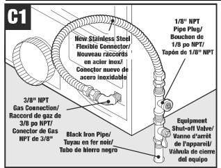
Attach approved natural gas pipe connection per local codes./Fixez le raccordement du tuyau de gaz naturel selon les règlements locaux./ Instale la conexión aprobada de la tubería del gas natural de acuerdo con los códigos locales.
