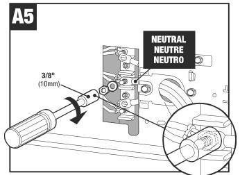
Attach neutral wire to center post. (*NOTE: Use deep well nut driver for all connections to assure tight fit on all terminals.*)/Raccordez le fil de neutre au goujon central. (*Remarque : Utilisez une douille profonde pour tous les raccordements pour vous assurer que toutes les bornes sont bien serrées.*)/Instale el alambre neutro a la clavija central. (*Nota: Use la llave de tuercas de casquillo profundo para todas las conexiones a fin de asegurar un ajuste apretado en todos los bornes.*)
