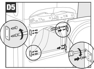
Attach hinges and hinge covers in new positions./Fixez les charnières et les couvercles de charnières dans leurs nouvelles positions./Instale las bisagras y las cubiertas de las bisagras en sus nuevas posiciones.
