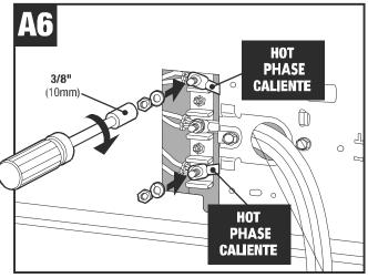
Attach hot wires./Raccordez les fils des phases./ Instale los alambres calientes.
