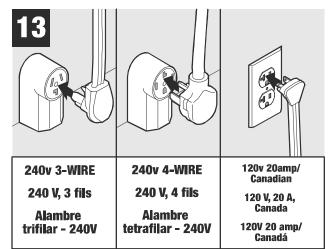
Plug in unit./Branchez l'appareil./Enchufe la secadora.
