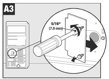
Remove metal cover to access wire connections./Enlevez le couvercle métallique pour accéder aux raccordements./Retire la cubierta de metal para tener acceso a las conexiones de los cables.
