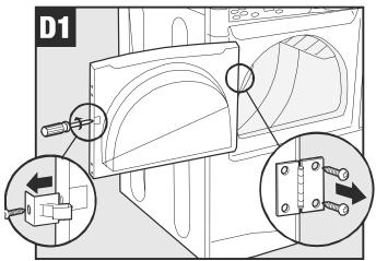
Remove screws holding door latch and door hinges./Enlevez les vis maintenant le système de verrouillage et les charnières./Retire los tornillos que sujetan el seguro de la puerta y las bisagras de la puerta.
