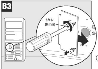
Remove metal cover to access wire connections./Enlevez le couvercle métallique pour accéder aux raccordements./Retire la cubierta de metal para tener acceso a las conexiones de los alambres.
