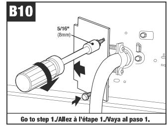
Replace wire connections metal cover./Remettez le couvercle métallique./ Vuelva a colocar la cubierta metálica de las conexiones de los alambres.
