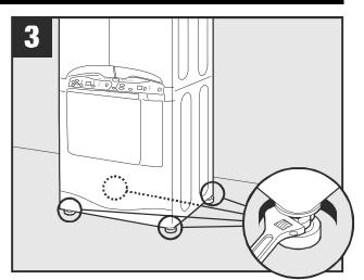
Loosen lock nuts before moving dryer to final position./Desserrez les écrous de blocage avant de déplacer la sécheuse dans sa position définitive./Afloje las contratuercas antes de mover la secadora a su lugar definitivo.
