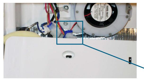
Tight fit for Evaporator fan plug.
