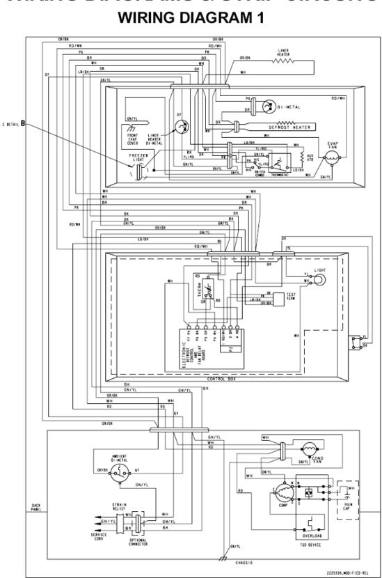
**WIRING DIAGRAMS & STRIP CIRCUITS**
