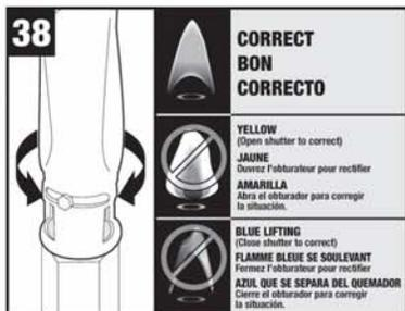
If necessary, adjust both oven burner shutters for correct flames. Secure shutter opening with screw./Au besoin, ajustez les deux obturateurs du brûleur du four pour obtenir les flammes appropriées. Fixez l'obturateur avec la vis./De ser necesario, ajuste ambos obturadores del quemador del horno para obtener la llama correcta. Fije la abertura del obturador con el tornillo.
