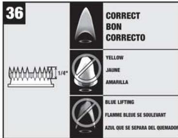
Correct flame height and appearance./Flamme de hauteur et d'aspect appropriés./Altura y apariencia correctas de la llama.
