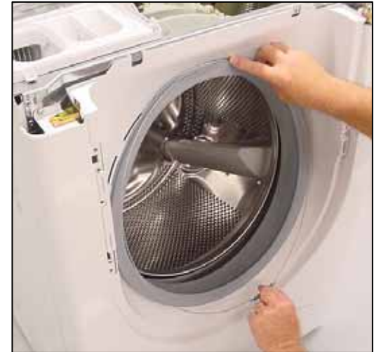
Remove door seal spring
