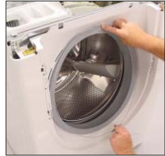
Remove door seal spring
