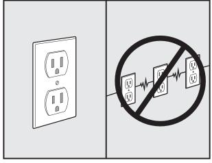
Washer outlet should be on its own circuit./La prise de la laveuse doit être sur un circuit indépendant./El tomacorriente de la lavadora debe estar en un circuito independiente.
