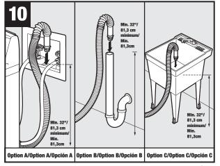
Fully insert cuff into drain pipe, approximately 3 in., or drape over sink rim./ Insérez complètement l'extrémité du tuyau d'évacuation dans le tuyau vertical, d'environ 3 po, ou placez-le sur le bord de l'évier./Instale completamente el extremo en la tubería de desagüe, aproximadamente 3 pulg., o colóquela sobre el borde del fregadero.
