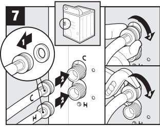
Place washers in hoses and attach to machine; take care to match up the hot and cold hoses to the correct inlet valve./Mettez les joints dans les tuyaux et froide aux robinets appropriés./Coloque las arandelas en las mangueras e del agua caliente y fría con las válvulas de admisión correctas.
