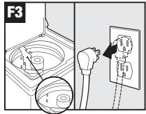
When water stops flowing, turn off unit and unplug from outlet./Quand l'eau s'arrête de couler, mettez la laveuse à l'arrêt et débranchez-la./Cuando el agua deje de correr, apague la lavadora y desenchúfela.
