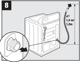
Pull out the drain hose until it stops, approximately 4 ft./Tirez sur le tuyau d'évacuation au maximum, soit environ de 4 pi./Tire de la manguera de desagüe hasta que se detenga, aproximadamente 4 pies.
