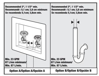
Minimum of 23 gallons per minute; Recommended 2" diameter standpipe/ Minimum de 23 gallons par minute; tuyau vertical d'évacuation – diamètre recommandé : 2 po//Mínimo de 23 galones por minuto; se recomienda un tubo vertical de evacuación de 2" de diámetro
