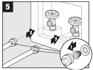
Place screens and washers in hoses./Installez les tamis et les joints dans les tuyaux./Coloque las mallas y arandelas en las mangueras.
