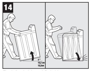
Tilt washer forward and release gently./Penchez la laveuse en avant et reposezla doucement./Incline la lavadora hacia adelante y suéltela delicadamente.
