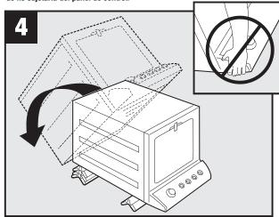
Gently return to upright position; take care not to hold the control panel./ Relevez doucement la laveuse, sans la tenir par le tableau de commande./ Vuélvala delicadamente a la posición vertical, teniendo cuidado de no sujetarla del panel de control.
