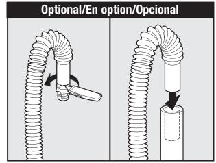
If the cuff of the hose does not fit into your stand pipe, cut off as shown./Si l'extrémité du tuyau ne pénètre pas dans le tuyau vertical, coupez-la, comme il est illustré./Si el extremo de la manguera no calza en su tubo vertical de evacuación, córtela como se muestra.
