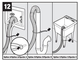
Secure drain hose with tie strap as shown./Fixez le tuyau d'évacuation avec l'attache, comme il est illustré./Asegure la manguera de desagüe con la atadura como se muestra.
