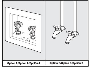
Minimum 25-125 psi water pressure at machine/Pression minimale à l'arrivée d'eau de la laveuse : 25 – 125 lb/po²/Presión mínima del agua de entrada a la lavadora: 25-125 lbs./pulg.²
