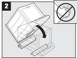
Gently lay washer on its back; take care not to hold the control panel./ Couchez doucement la laveuse sur l'arrière, sans la tenir par le tableau de commande./ Coloque delicadamente la lavadora sobre su parte trasera, teniendo cuidado de no sujetarla del panel de control.
