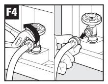
Disconnect inlet hoses from faucets./Déconnectez les tuyaux d'arrivée au niveau des robinets./ Desconecte las mangueras de admisión del agua de las llaves.
