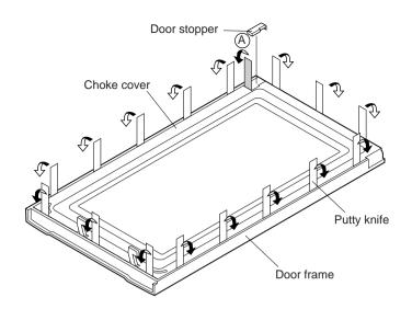
Figure C-3. Door Disassembly
