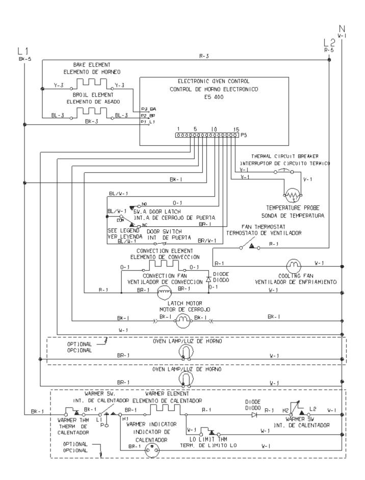
SAMPLE SCHEMATIC FOR THE ES 400 CONTROL SYSTEM
