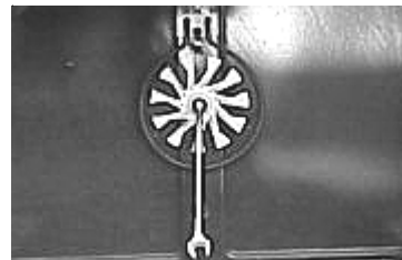
Removing fan blade
