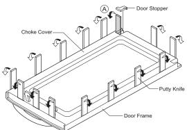
Figure C-3. Door Disassembly
