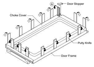
Figure C-3. Door Disassembly
