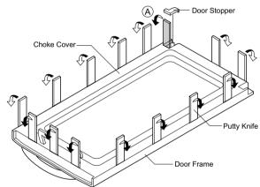
Figure C-3. Door Disassembly
