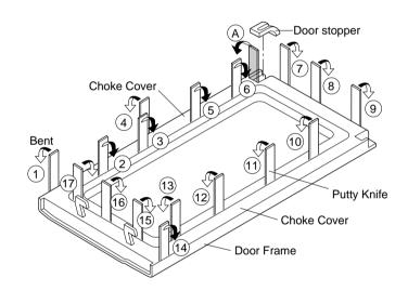
Figure C-3. Door Disassembly
