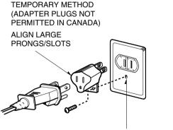
ENSURE PROPER GROUND AND FIRM CONNECTION BEFORE USE
