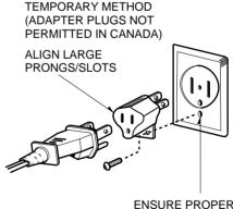
ENSURE PROPER GROUND AND FIRM CONNECTION BEFORE USE
