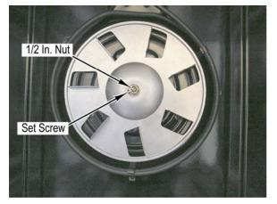
3. Lift the fan blade from the fan motor shaft.
