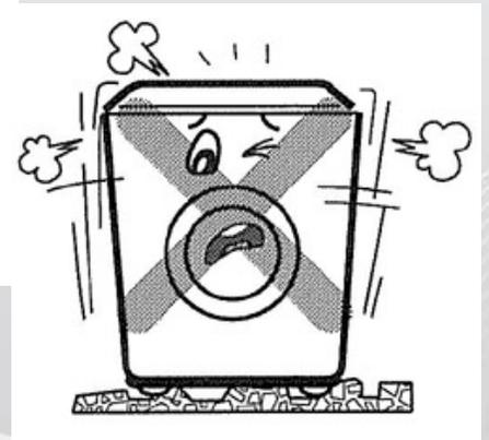
INSTALL THE WASHER ON A FIRM, FLAT SURFACE.
