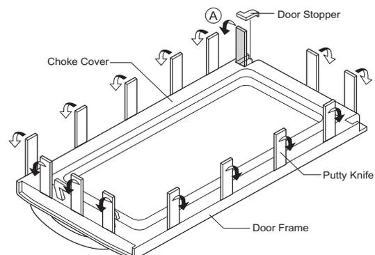
**Figure C-3. Door Disassembly**
