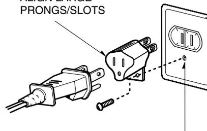
ENSURE PROPER GROUND AND FIRM CONNECTION BEFORE USE
