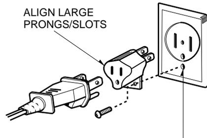
ENSURE PROPER GROUND AND FIRM CONNECTION BEFORE USE
