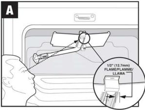
Check flame height and color./Vérifiez la hauteur et la couleur de la flamme./Verifique la altura y el color de la llama.
