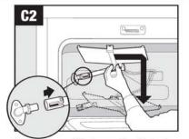
Slip the burner off the brass orifice./Sortez le brûleur du gicleur en laiton./Deslice el quemador para sacarlo del orificio de bronce.
