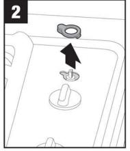
Remove spill gasket./Enlevez le joint antidébordement./Retire la junta de derrames.
