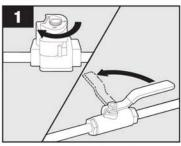
Turn off gas supply shut-off valve./Fermez le robinet d'arrêt d'alimentation en gaz./Cierre la válvula de cierre del gas.
