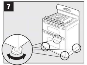
Adjust legs./Ajustez les pieds./Ajuste los tornillos niveladores.
