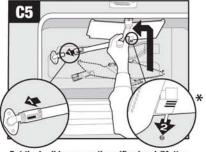
Put the broil burner on the orifice hood./Mettez le brûleur de gril sur la tête de gicleur./Coloque el quemador de asar en la tapa del orificio.
