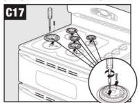
Remount burner heads./Remontez les têtes de brûleur./Vuelva a instalar las cabezas de los quemadores.
