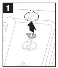
Remove rear burner knob./Enlevez le bouton du brûleur arrière./Retire la perilla del quemador trasero.
