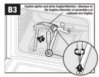
Remove burner./Enlevez le brûleur./Retire el quemador.
