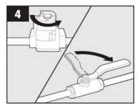
Turn on gas supply shut-off valve./Ouvrez le robinet d'alimentation en gaz./Abra la válvula de cierre del gas.
