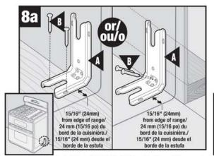
Drill 1/8" (3mm holes). Mount ANTI-TIP bracket to wall or floor with 2 screws./ Percez des trous de 1/8 po (3 mm). Installez le support ANTIRENVERSEMENT au mur ou au sol avec deux vis./Taladre agujeros de 1/8" (3 mm). Instale el soporte ANTIVUELCO en la pared o en el piso usando 2 tornillos.
