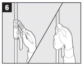
Check all gas connection joints and fittings for leaks with a non-corrosive leak detection fluid, then wipe off./Vérifiez l'absence de fuite à tous les raccordements de gaz avec un liquide de détection des fuites non corrosif, puis essuyez-le./Verifique todas las conexiones y juntas del suministro de gas a la estufa usando un liquido de detección de escapes no corrosivo para asegurarse de que no hayan escapes. Limpie el líquido cuando haya terminado.
