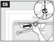
Re-position the broil burner and tighten screw./ Remettez en place le brûleur de gril et serrez la vis./Vuelva a colocar el quemador de asar en su lugar y apriete el tornillo.
