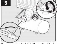
Turn on gas supply at tank./Ouvrez l'arrivée de gaz au réservoir./Abra el suministro de gas en el tanque.
