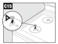
Add choke to left front orifice holder only./ Ajoutez un étrangleur au support de gicleur avant gauche seulement./Agregue un obturador en el soporte del orificio delantero izquierdo únicamente.
