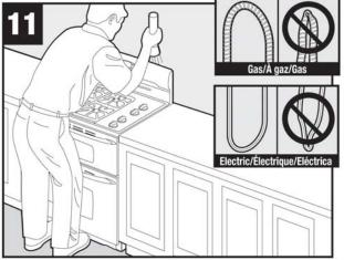
Make sure flexible connector and electrical cord are not bent./Assurezvous que le tuyau de raccordement flexible et le cordon électrique ne sont pas pliés./Asegúrese de que el conector flexible y el cordón eléctrico no estén doblados.
