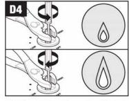
Adjust flame height with screwdriver./Ajustez la hauteur de la flamme avec le tournevis./Ajuste la altura de la llama con el destornillador.
