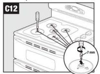
Remove orifices. Insert tape into nut driver to hold orifice. IMPORTANT: KEEP orifices for later conversion./Enlevez les gicleurs. Mettez un bout de ruban adhésif dans le tourne-écrou pour retenir le gicleur. IMPORTANT : CONSERVEZ les gicleurs pour une conversion ultérieure./Retire los orificios. Coloque cinta adhesiva en la llave para tuercas para sostener el orificio. IMPORTANTE: GUARDE los orificios para posteriores conversiones.
