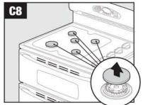
Remove the burner tops./Retirez les chapeaux de brûleur./Retire las tapas de los quemadores.
