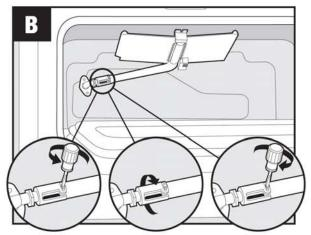
Adjust by opening air shutter./Ajustez en ouvrant l'obturateur d'air./ Ajuste abriendo el obturador.
