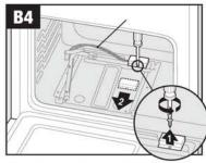
Remove the cover over the orifice./Retirez le couvre-gicleur./Retire la cubierta que está sobre el orificio.
