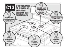
Replace with correct LP(propane) gas orifice. DO NOT OVERTIGHTEN./Remplacez avec le bon gicleur pour GPL SANS TROP SERRER./Reemplace con los orificios de gas LP (propano) correctos. NO APRIETE DEMASIADO.
