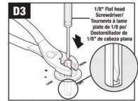
Hold knob stem in LOW position. Insert screwdriver to engage screw./Tenez la tige du bouton en position LOW. Introduisez le tournevis pour tourner la vis./ Mantenga la varilla de la perilla en el ajuste 'LOW' (Bajo). Inserte el destornillador en el tornillo.
