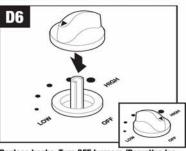
Replace knobs. Turn OFF burners./Remettez les boutons. Mettez les brûleurs sur OFF (ARRÊT)./Vuelva a instalar las perillas. APAGUE los quemadores.
