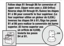
Conversion of broil burner to LP/Conversion du brûleur de gril au GPL/Conversión del quemador de asar a gas LP
