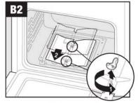
Remove oven baffle./Enlevez le déflecteur de four./Retire el deflector del horno.
