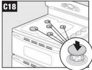
Replace burner caps./Remettez les chapeaux de brûleur./Vuelva a instalar las tapas de los quemadores.
