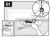
Remove screw and slide the broil burner forward until the pin clears rear wall./Enlevez la vis et faites glisser en avant le brûleur de gril jusqu'à ce que le tenon se trouve dégagé de la paroi arrière./Retire el tornillo y deslice el quemador de asar hacia adelante hasta que el pasador quede libre de la pared trasera.
