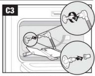
Remove orifice hood./Retirez la tête de gicleur./ Retire la tapa del orificio.
