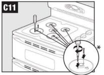
Replace screws./Remettez les vis./Reemplace los tornillos.
