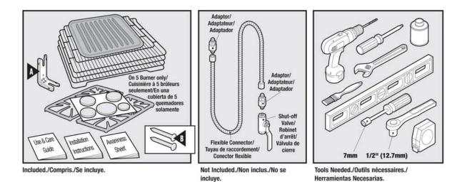
If you have LP (propane) find instructions and parts in kit on rear of range below regulator./ Dans le cas de GPL (propane), les instructions et les pièces se trouvent dans un nécessaire à l'arrière de la cuisinière sous le détendeur./ Si cuenta con un suministro de gas LP (propano), puede encontrar instrucciones y un kit de piezas en la parte trasera de la estufa debajo del regulador.
