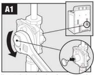
Unscrew the hex shaped cap from the neck of the regulator./Dévisssez le chapeau hex. du col du détendeur./Desenrosque la tapa hexagonal del cuello del regulador.
