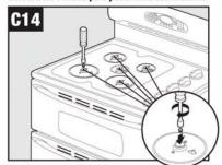
NOTE: Put tape in nut driver to secure orifice in nut driver before replacing orifice./REMARQUE : Mettez du ruban adhésif dans le tourne-écrou pour retenir le gicleur avant de le remettre en place./NOTA: Coloque cinta adhesiva en la llave para tuercas para fijarla al orificio antes de reemplazarlo.
